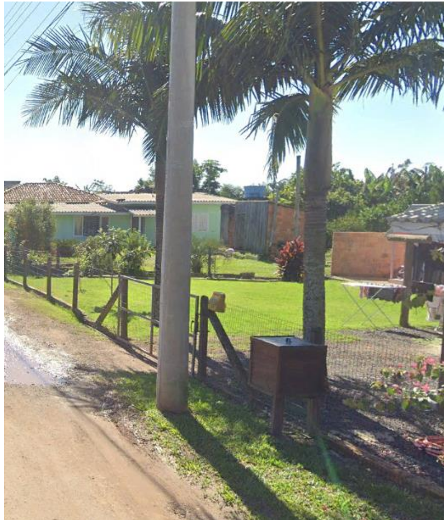
Figura 12 - Largura mínima da faixa livre de passeio não respeitada e obstáculos no caminho
